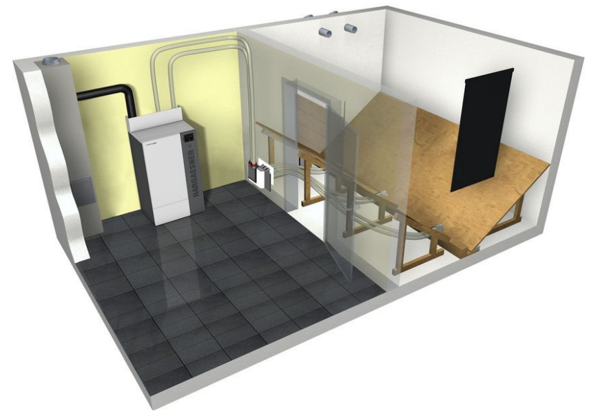
Pelletkessel und Pelletslager (Quelle: Heitzmann AG)
